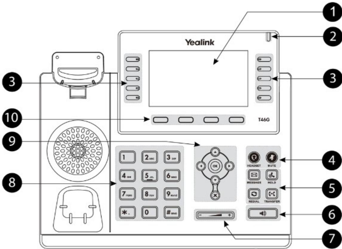
Questi tasti permettono l'accesso a differenti funzioni in base alla scritta che compare sullo schermo del telefono in prossimità di ogni singolo tasto.
